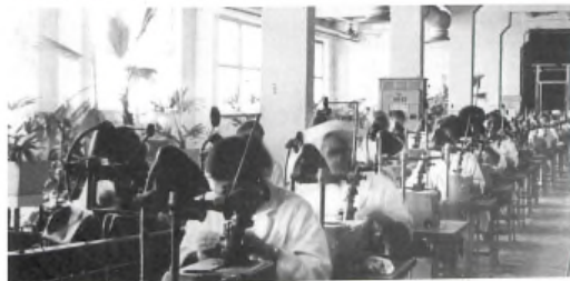
Участок изготовления торональных трансформаторов. Линия станков торональной намотки.
